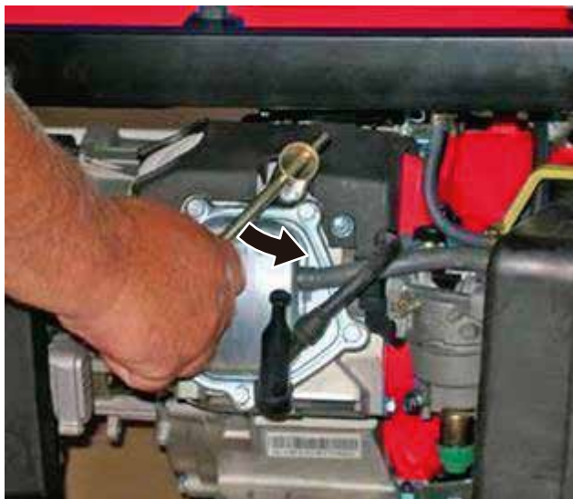
Figura 37 – Procedimiento para extraer la bujía
