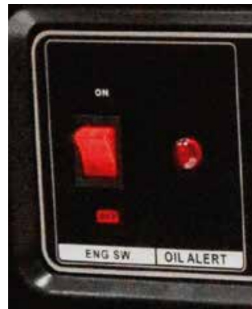
Figura 24 – Interruptor de control del motor
