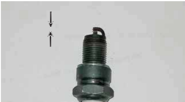
Figura 38 – Requisitos de separación de la bujía
