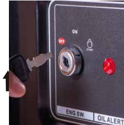
Figura 19 – Interruptor de control del motor
