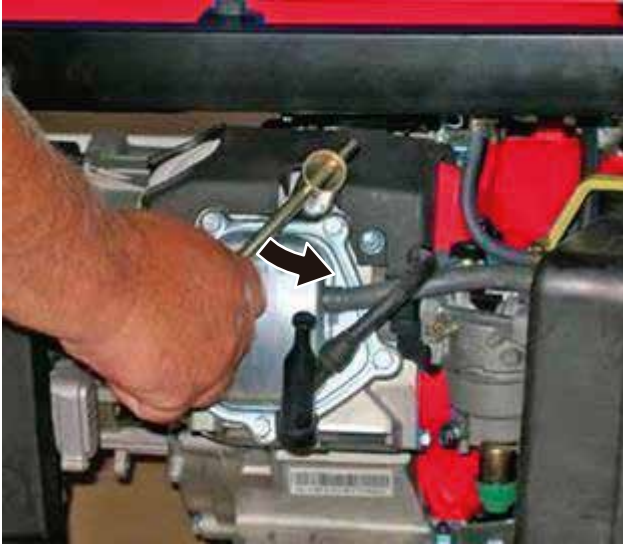
Figura 37 – Procedimiento para extraer la bujía
