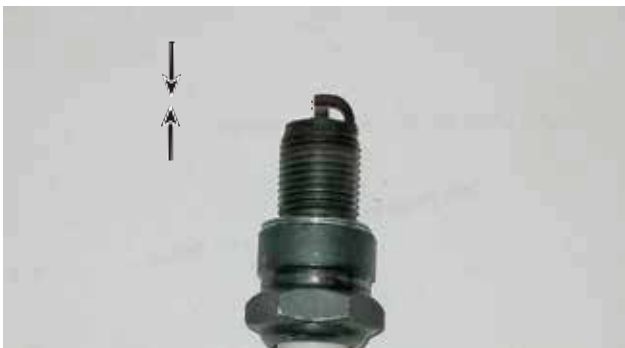
Figura 38 – Requisitos de separación de la bujía
