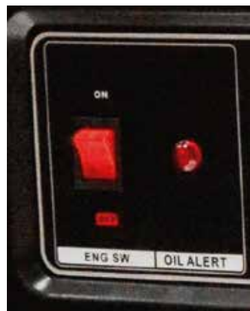
Figura 24 – Interruptor de control del motor
