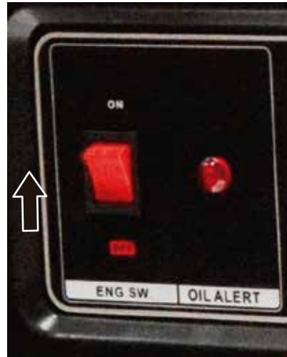
Figura 19 – Interruptor de control del motor
