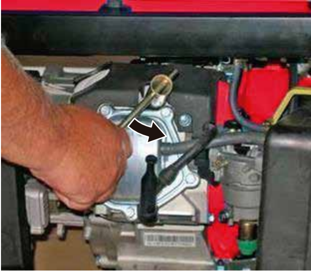
Figura 37 – Procedimiento para extraer la bujía
