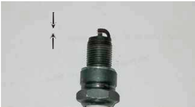
Figura 38 – Requisitos de separación de la bujía
