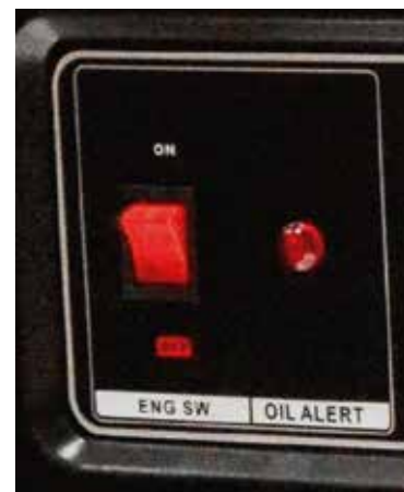
Figura 24 – Interruptor de control del motor
