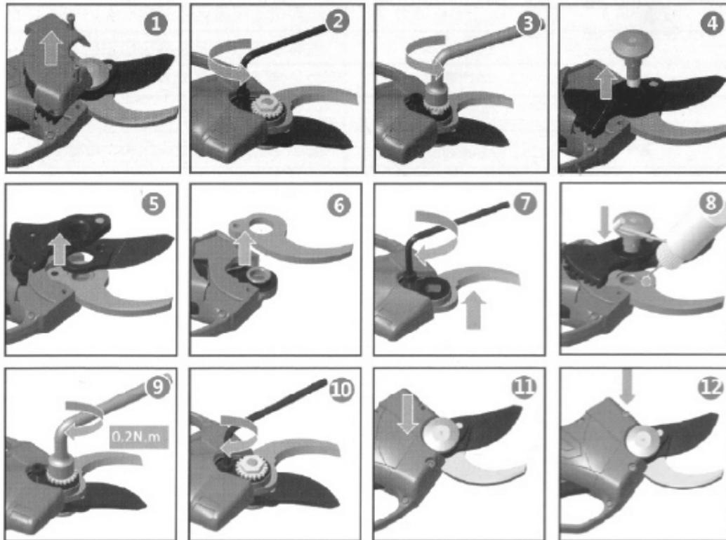
Las hojas fijas y móviles pueden ser reemplazadas individualmente; no se preocupe por el tamaño de la abertura de la cuchilla de reemplazo, la apertura volverá automáticamente a su tamaño normal durante el encendido después de completar el cambio de cuchilla.
