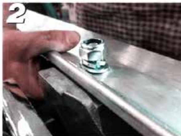
2 Coloque arandelas, tornillos de bloqueo y pernos
