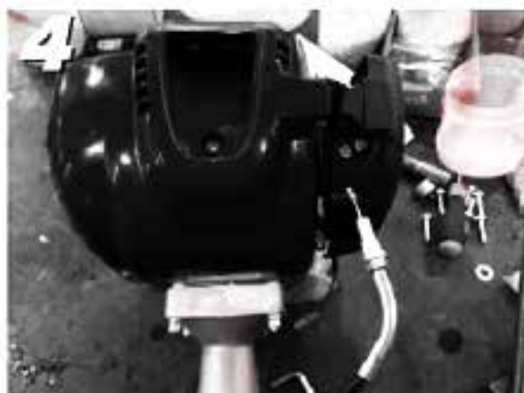
4 Conecte el cable del acelerador al motor
