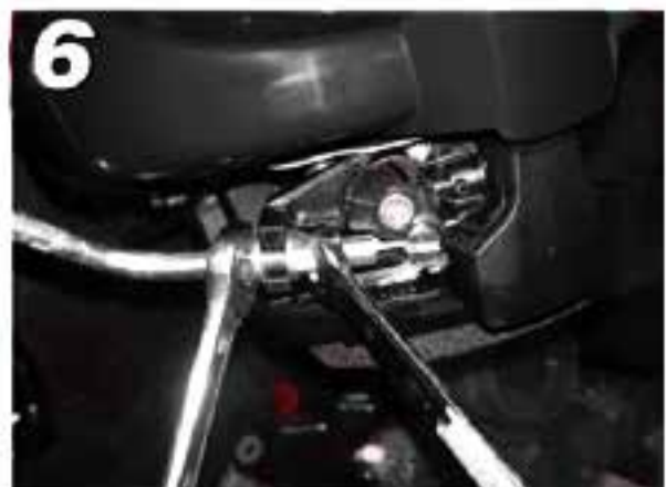
6 Apriete y asegúrese de que cuando tire de la manija del acelerador, el cable engrane el motor.
