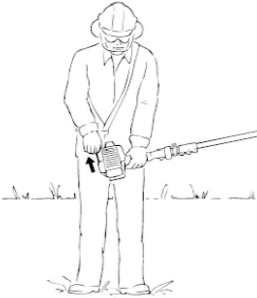
Retire la protección de la cadena. Coloque el eje en una rama de modo que quede sujeto por el gancho. Sujete la unidad firmemente con la mano izquierda en la carcasa del ventilador; su pulgar debe estar debajo de la carcasa del ventilador. Sujete la empuñadura del motor de arranque con la mano derecha. Tire lentamente de la empuñadura del motor de arranque hasta que sienta que se engancha y, a continuación, tire de él con fuerza.
