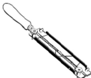
Los ángulos A y B especificados se obtienen automáticamente si se utilizan las limas o herramientas de afilado recomendadas y los ajustes correctos. Los ángulos deben ser los mismos en todos los cortadores. Si los ángulos son desiguales: la cadena correrá de manera irregular, no en línea recta, se desgastará rápidamente y finalmente se romperá. Como estos requisitos solo se pueden cumplir después de una práctica suficiente y constante:
