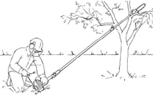
Retire la funda de la hoja. Compruebe que la cadena no toque el suelo ni ningún otro obstáculo. Coloque la unidad en el suelo: Debe descansar de forma segura sobre el soporte del motor y el gancho. Si es necesario, apoye el gancho en un soporte elevado (por ejemplo, una rama, montículo o algo).
