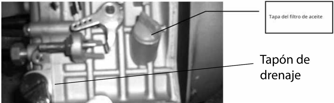
Asegúrese de drenar el aceite mientras el motor esté caliente. Es difícil drenar completamente el aceite después de enfriarlo.
