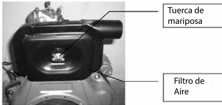
El elemento del filtro de aire debe cambiarse cuando la potencia del motor disminuye o el color del escape es anormal.
