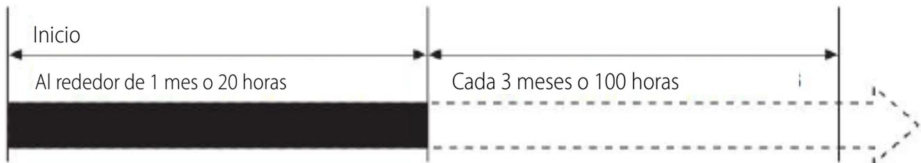
Intervalo de cambio de aceite de la máquina.- Asegúrese de verificar el nivel de aceite y rellenarlo hasta el nivel especificado antes de arrancar el generador, aunque esté equipado con un sistema de advertencia de baja presión de aceite
