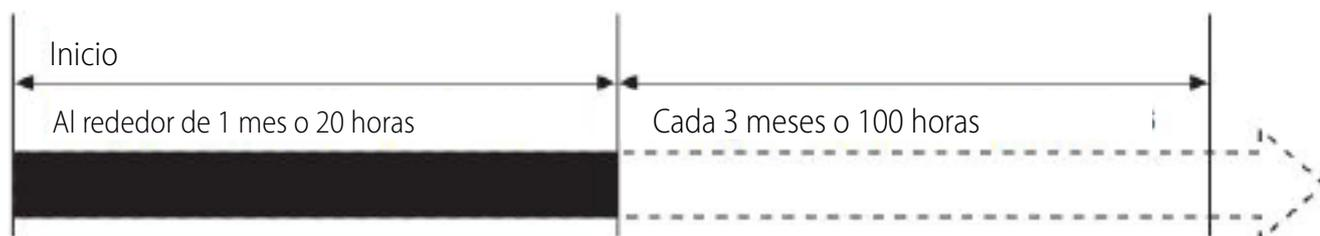
Intervalo de cambio de aceite de la máquina.- Asegúrese de verificar el nivel de aceite y rellenarlo hasta el nivel especificado antes de arrancar el generador, aunque esté equipado con un sistema de advertencia de baja presión de aceite
