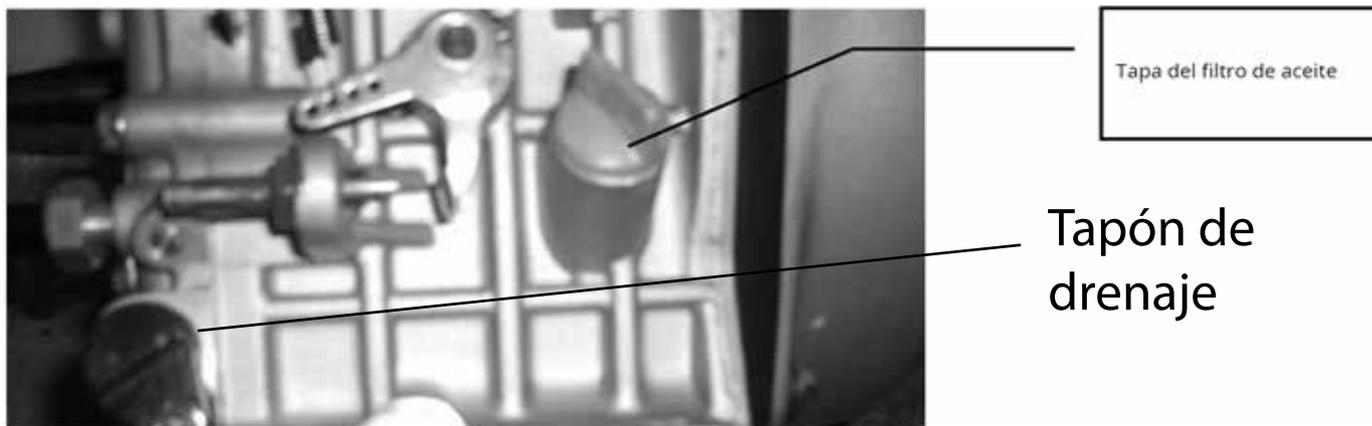
Asegúrese de drenar el aceite mientras el motor esté caliente. Es difícil drenar completamente el aceite después de enfriarlo.
