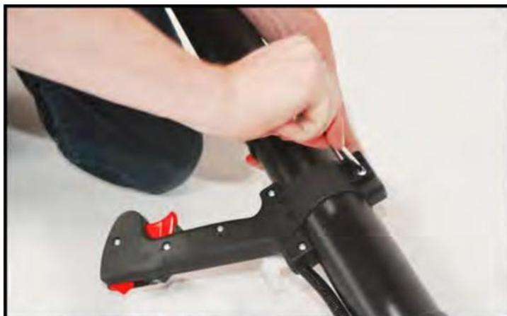
Deslice el mango del acelerador sobre el tubo de conexión (B) y apriete con el tornillo del kit de
