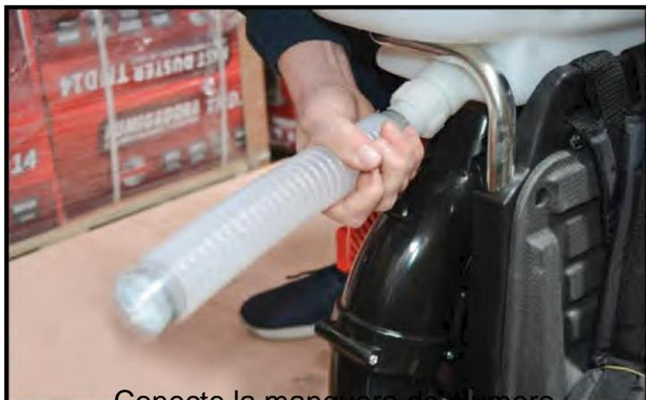
**11** Conecte la manguera de plumero flexible a la base del tanque químico
