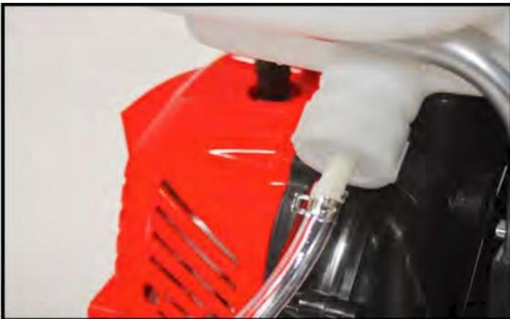
**9** Conecte el primer tubo transparente a la base del tanque químico
