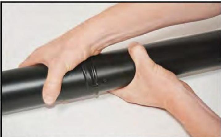
Conecte el tubo del soplador (C) uniendo el hoyuelo elevado a la guía de la ranura
