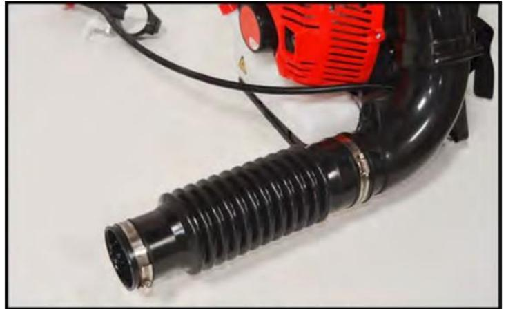
**2** Sujete el tubo acanalado (A) al codo del soplador
