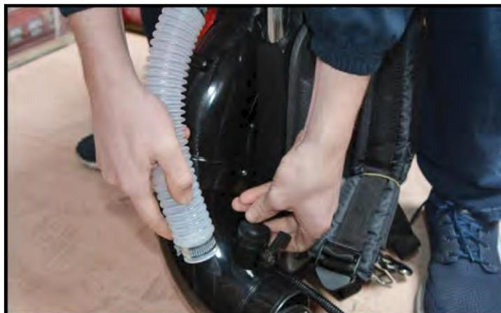
**12** Conecte el otro extremo de la manguera del plumero al codo
