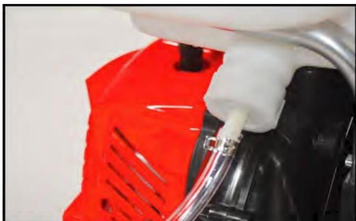
**9** Conecte el primer tubo transparente a la base del tanque químico
