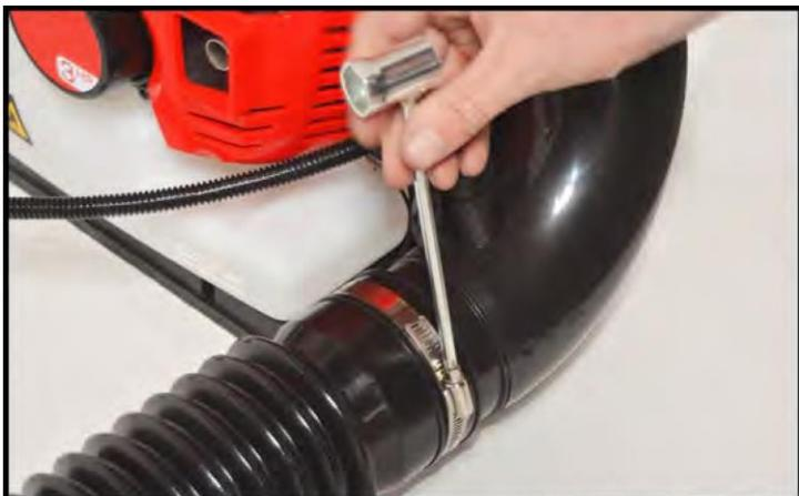
**3** Asegure el tubo acanalado con una abrazadera de manguera al codo del soplador
