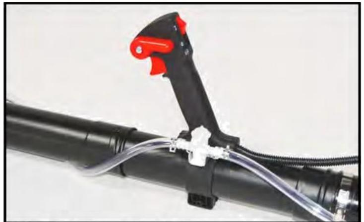
**10** Asegure los tubos transparentes del otro extremo a la parte posterior del acelerador y el segundo tubo al frente
