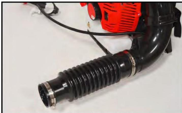
**2** Sujete el tubo acanalado (A) al codo del soplador
