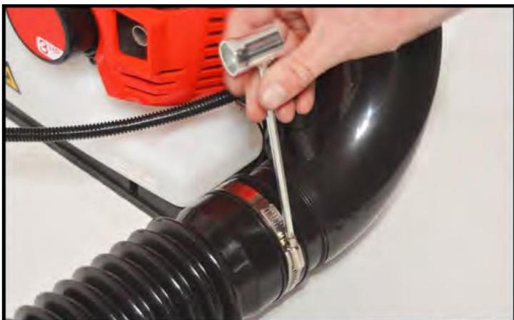
**3** Asegure el tubo acanalado con una abrazadera de manguera al codo del soplador
