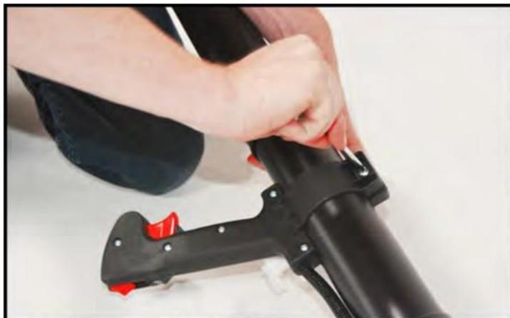
Deslice el mango del acelerador sobre el tubo de conexión (B) y apriete con el tornillo del kit de herramientas
