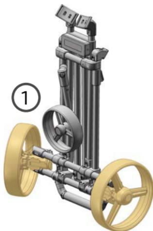
Replier les roues arrières vers l'extérieur jusqu'à la butée.
