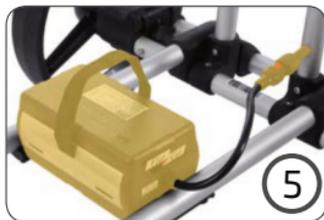
Installer la batterie et la raccorder au chariot: rouge sur rouge, noir sur noir. La batterie doit être complètement chargée pour que la LED s'allume au vert sur le chargeur. Le temps de charge est maximum de 6 heures.
