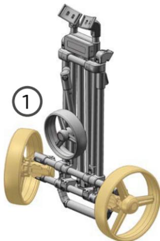
Räder nach außen klappen und einrasten lassen.
