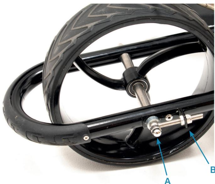
Desserrez les deux extrémités des écrous borgnes de l'essieu (A) d'environ un demi-tour. Si le chariot se déplace vers la gauche, avancez le côté gauche de l'essieu à l'aide des écrous de réglage (B) (tournez les deux écrous dans le sens inverse des aiguilles d'une montre). Si le chariot se déplace vers la droite, tournez les deux écrous (B) dans le sens des aiguilles d'une montre. Testez la trajectoire après chaque réglage. Il suffit de quelques ajustements mineurs.
