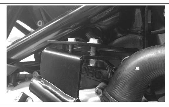
8. NOTE: THE ENGINE GUARD BRACKETS FIT UNDER THE FRAME BRACKETS.
