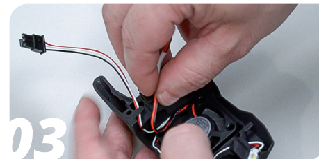
03 Insert the 4010 hotend cooling fan
