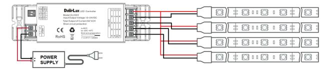
Application Circuit 2: CW+WW( V+→COMMON、CH1→CW、CH2→WW、CH3→CW, CH4: WW.)
