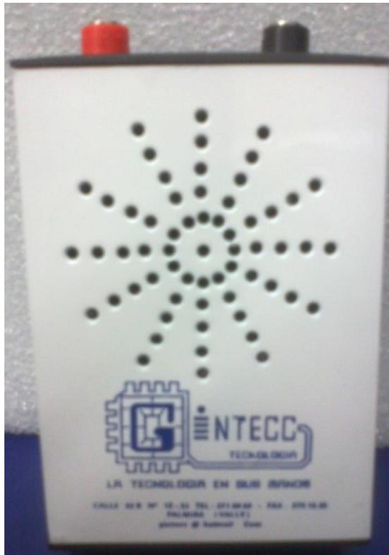
El sistema **TIMBRE PROBADOR DE CONTINUIDAD** es una versátil herramienta que le permite a un operario ejecutar pruebas de continuidad en cables conductores eléctricos, de una forma cómoda y con mayor eficiencia. Incluye en bobinas de cables no siendo afectado por las inductancias ni capacitancias generados por este tipo de almacenamiento.
