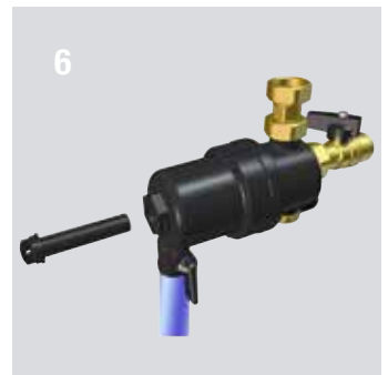
6 Después de unos segundos abrir ligeramente la válvula de paso aguas arriba para el lavado de las partes internas.
