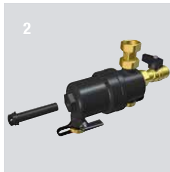
2 Desmontaje del imán (girar 90° en sentido horario)
