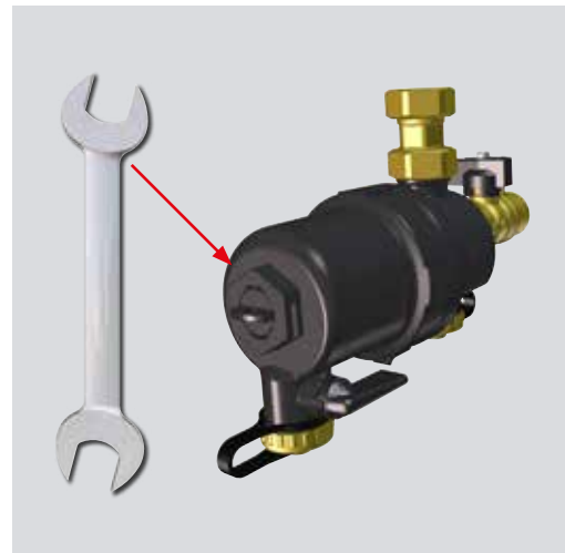
6 Después de unos segundos abrir ligeramente la válvula de paso aguas arriba para el lavado de las partes internas.
