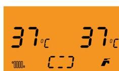
Para cambiar a la posición de agua del grifo, mantenga pulsado el botón MODE y suelte el botón después de completar el ciclo en la pantalla. En esa posición, el símbolo parpadea en la esquina inferior derecha de la pantalla y la temperatura de agua caliente sanitaria existente se verá en la pantalla y la luz de la pantalla se apagará.
