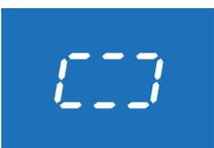
Para apagar la caldera, mantenga pulsado el botón MODE, mientras se inicia un círculo en la pantalla, suelte el botón cuando se complete el círculo.
