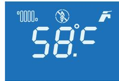
En esa posición, podrá ajustar la temperatura entre 35-60 °C con el botón de ajuste de la temperatura del agua caliente sanitaria (4) cuyo símbolo aparece en la pantalla. Cuando se gira el botón de ACS, mientras la luz de la pantalla está encendida si se gira (a la derecha) en el sentido de las agujas del reloj, se puede aumentar la temperatura, y se puede disminuir la temperatura cuando se gira en sentido contrario a las agujas del reloj (a la izquierda).
