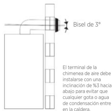
Figura 10 Inclinación del conducto de humos de condensación
