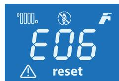
Un ejemplo de error de utilización; cuando los códigos de fallo E81 o E06 se muestran en la pantalla del dispositivo, ha pasado a fallo ya que no se ha producido el encendido en su dispositivo. En ese caso, cualquiera de las válvulas de la línea de gas conectadas a la caldera puede estar cerrada, la caldera mixta se reiniciará cuando se abra la válvula cerrada y se pulse el botón RESET. Si la caldera no se pone en marcha con el reinicio, por favor, consulte a nuestro Servicio Autorizado.
