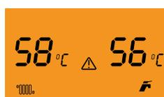
En esa posición, puede ajustar la temperatura del agua caliente del grifo entre 35-60 °C con los botones numerados (7) y (8) debajo del botón RESET. La pantalla se ilumina durante el cambio de temperatura, el símbolo de ACS parpadea junto al valor de la temperatura de ACS. El valor de ajuste se confirma después de que la luz de la pantalla se apague tras el ajuste.
