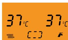
Si está arrancando la caldera por primera vez, mantenga pulsado el botón MODE, y suelte el botón después de que el ciclo se haya completado en la pantalla, inicialmente de la caldera cambia a la posición de radiador, su símbolo parpadeará en la esquina superior izquierda de la pantalla la temperatura de la instalación del radiador existente y la luz de la pantalla se apagará.
