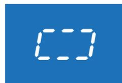
Si está arrancando la caldera por primera vez, mantenga pulsado el botón MODE, y suelte el botón después de que el ciclo se complete en la pantalla, inicialmente la caldera cambia a la posición de radiador, su símbolo parpadeará en la esquina superior izquierda de la pantalla, la temperatura de la instalación del radiador existente se indicará en la pantalla y la luz de la pantalla se apagará.
