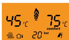
En algunos casos, de la caldera se pone inicialmente en posición de radiador, su símbolo parpadea en la esquina inferior izquierda de la pantalla y el símbolo del grifo se ve en la esquina inferior derecha. Un manómetro digital que indica la presión de la instalación se encuentra en la parte inferior central de la pantalla y también la temperatura de la instalación del radiador existente se ve en la pantalla al mismo tiempo y la luz de la pantalla se apaga.
