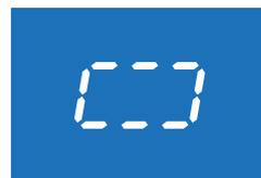
Para cambiar a la posición de ACS, mantenga pulsado el botón MODE y suelte el botón una vez que se haya completado el ciclo en la pantalla. En esa posición, el símbolo parpadea en la esquina superior derecha de la pantalla y la temperatura de ACS existente se verá en la pantalla y la luz de la pantalla se apagará.
