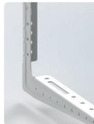
Máxima resistencia gracias al plegado por estampación de una sola hoja de acero de 2 mm. Sin soldaduras o uniones mecánicas.
