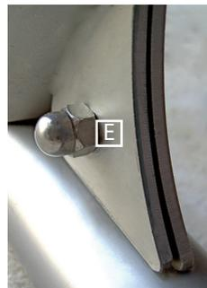
Die beiden Dreieckflanschen liegen genau aneinander und werden mit der Schraube/ Hutmutter fest verschraubt.
