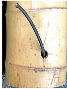
Rebschnur durch 8mm Loch am Bambusrohr ziehen und am Ende mit Knoten sichern.
