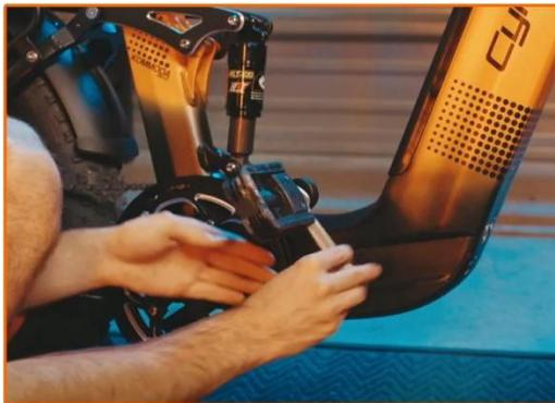
23 取り付け後、ペダルをレンチで固定します
