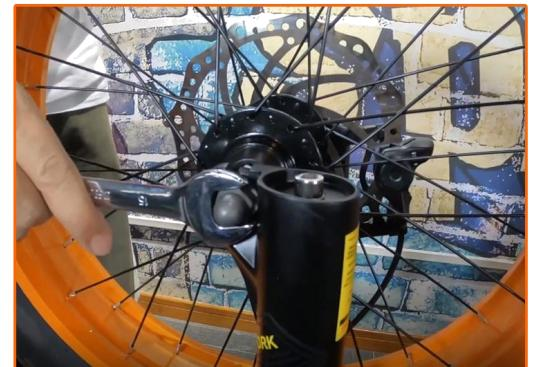
9 両端のナットを締めて固定します
