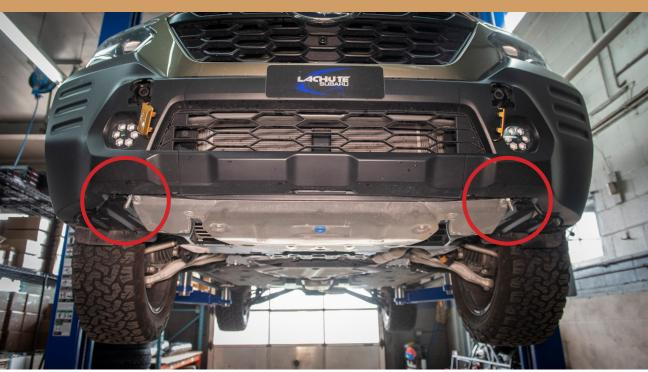
\*IF YOU ARE PLANNING ON INSTALLING A LIGHT BAR, WE SUGGEST YOU INSTALL IT BEFORE MOUNTING THE BUMPER GUARD.
