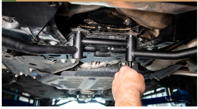
CHECK TO MAKE SURE ALL THE GAPS BETWEEN THE BUMPER AND BUMPER GUARD ARE EQUAL. YOU CAN ADJUST THE HEIGHT USING THE NUTS ON THE SUPPORTS RODS.
