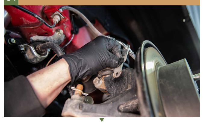
INSTALL THE BRAKE LINE TO THE BRAKE LINE SPACER
