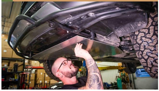
\*\*IF YOU HAVE THE FULL ARMOR OPTION ON YOUR BUMPER GUARD, THE SKID PLATE GETS INSTALLED INBETWEEN THE BUMPER GUARD AND FULL ARMOR\*\*
