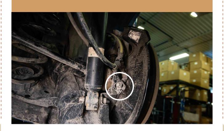
PUT BACK THE BRAKE LINE AND RE INSTALL THE CLIP
