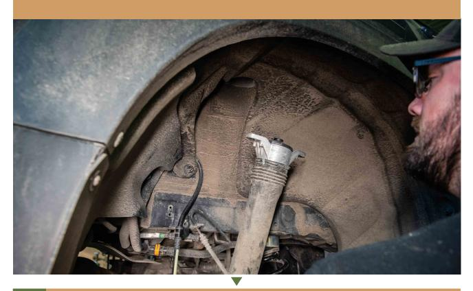
26 INSTALL THE SHOCK SPACERS. MAKE SURE THE ARROW POINTS TOWARDS THE FRONT OF THE VEHICLE AND THAT THE CORRECT SIDE IS USED
