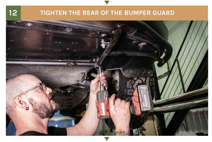
MAKE SURE ALL THE GAPS ARE EQUAL THEN TIGHTEN THE NUTS ON THE SUPPORT RODS.
