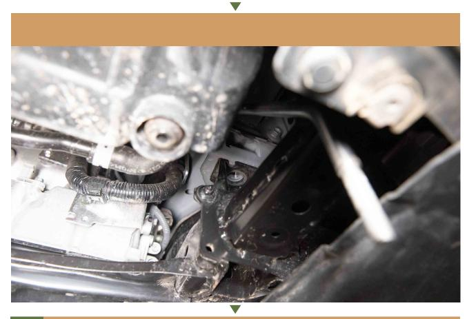
6 MAKE THE HOLES IN THE PLASTIC SPLASH GUARD USING THE INCLUDED TEMPLATE
