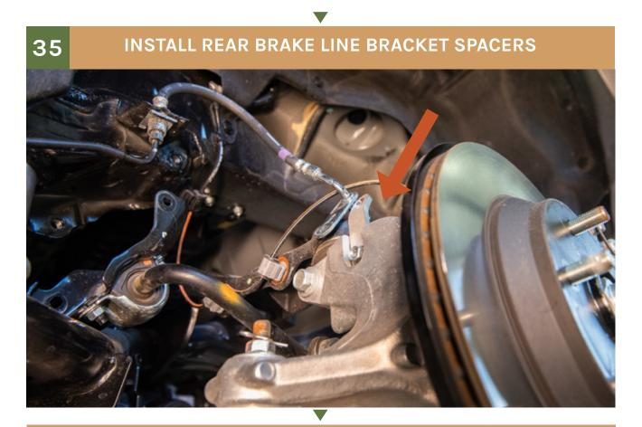
MAKE SURE THE BRAKE LINE BRACKET IS ANGLED AWAY FROM THE BRAKE DISK
