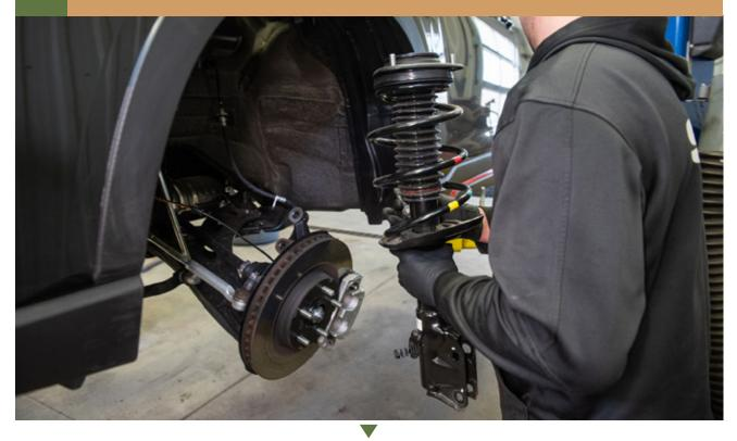
8 INSTALL TOP PLATE SPACER USING THE FACTORY NUTS. USE A PRY BAR TO HELP STABILIZE THE STRUT WHILE TIGHTENING
