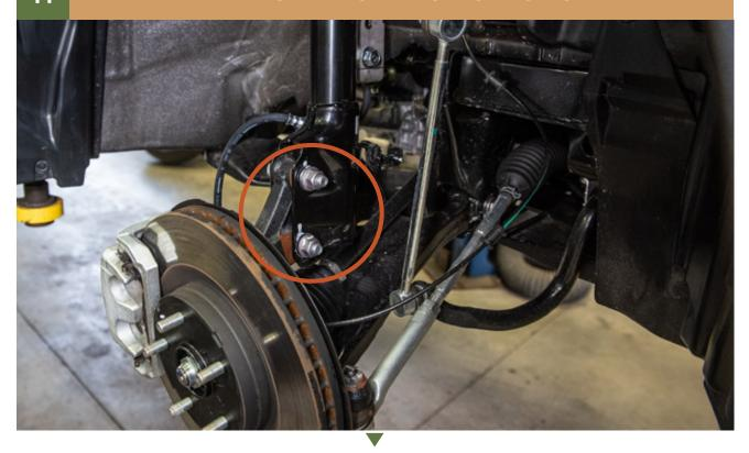
12 INSTALL BRAKE LINE BRACKET SPACER
