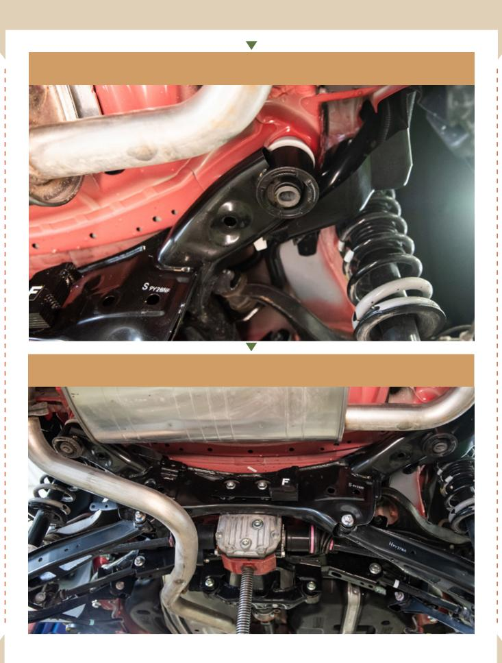
28 SLOWLY LOWER THE SUB FRAME DOWN JUST ENOUGH TO BE ABLE TO INSTALLL THE SUB FRAME SPACERS
