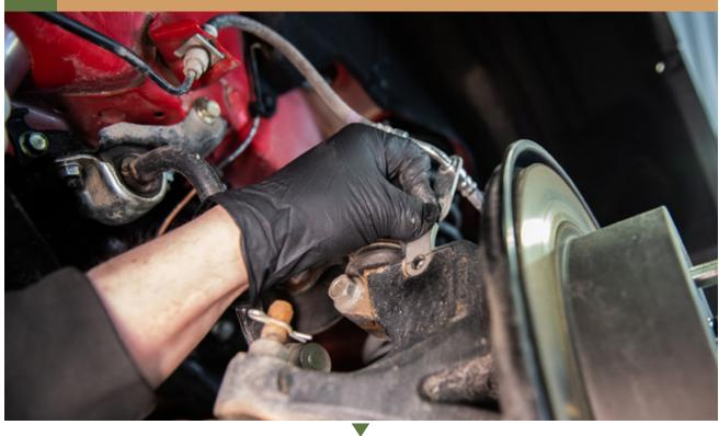
INSTALL THE BRAKE LINE TO THE BRAKE LINE SPACER \*MAKE SURE TO ANGLE THE BRAKE LINE BRACKET TOWARDS THE INSIDE OF THE VEHICLE
