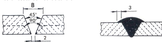
Giunto da saldare preparato
