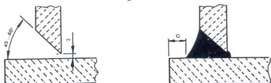
Giunto da saldare preparato
