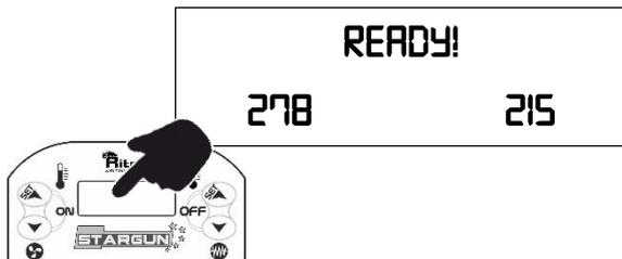
Die Temperaturen bezüglich der Plastifizierungskammer und der Vorwärme-Luft entsprechen der letzten Schweißung. Um diese Werte zu ändern, befolgen Sie folgende Anweisungen:
