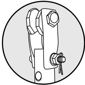
**IMPORTANT :** vérifier que la goupille de sécurité est insérée et ouverte à l'aide d'une pince. Cela permet d'assurer que le ventilateur ne tombe pas en cas de desserrage des fixations
