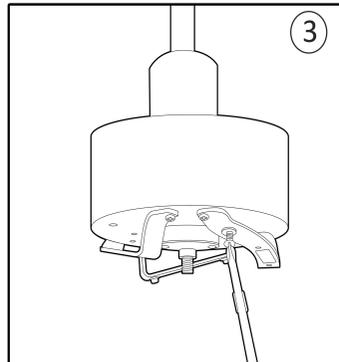
**3** Retirer les vis des pales et mettre de côté
