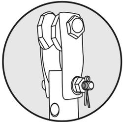
**IMPORTANT :** vérifier que la goupille de sécurité est insérée et ouverte à l'aide d'une pince. Cela permet d'assurer que le ventilateur ne tombe pas en cas de desserage des fixations
