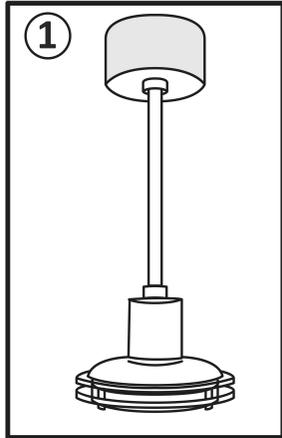
1. - Prenez le moteur du ventilateur et insérez la tige dans l'assemblage d'accroche du plafond
