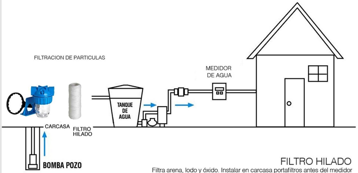
Filtra arena, lodo y óxido. Instalar en carcasa portafiltros antes del medidor
