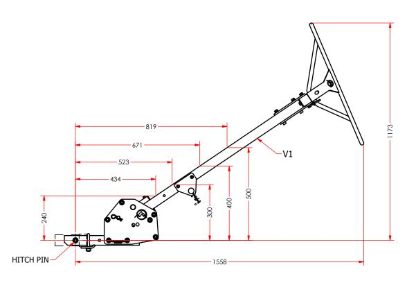
V1 MULTI PIVOT - COMPLETELY LAID BACK (UNLOCKED) ACCESS ONLY
