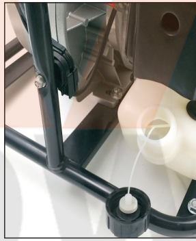
2. Add mixed fuel Mixture rate 25:1
