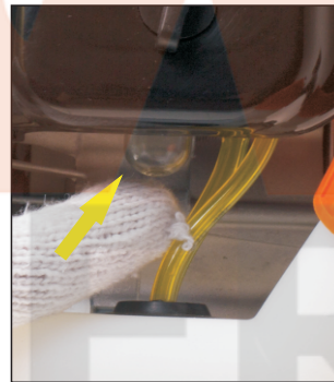
3. Press primer bulb 5 times
