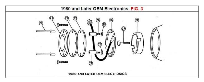
Step #2. COMPU-FIRE® IGNITION MODULE INSTALLATION
