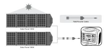
**Bitte beachten Sie:** Bitte verwenden Sie unser Standard-Solarpanel und den Adapter, um das Gerät aufzuladen. Andernfalls kann das Gerät möglicherweise nicht normal aufgeladen werden. In schweren Fällen kann dies zu einer verkürzten Lebensdauer führen und das Gerät kann durch einen Kurzschluss beschädigt werden.
