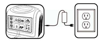
**Bitte beachten Sie:** Bitte verwenden Sie ausschließlich unsere Standard-Solarmodule und Adapter, um das Gerät aufzuladen. Andernfalls kann es zu einer unzureichenden Aufladung kommen, die die Lebensdauer des Geräts verkürzen und im schlimmsten Fall durch einen Kurzschluss beschädigt werden kann.
