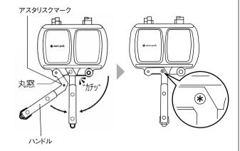
ハンドルをセットしたときに、手ごたえが緩いと感じた場合、ハンドルを元に戻し、 以下の手順にて金具を調整してください。
