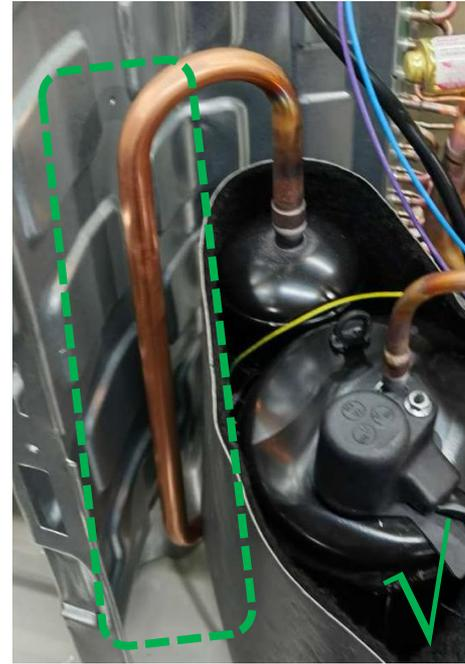
**Solución:** Ajuste suavemente el tubo de cobre para asegurarse de que queda a más de 15 mm de la chapa y otros tubos.
