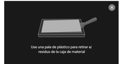
Retire la lámina de resina con un rascador de plástico
