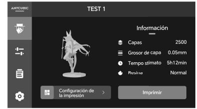
6. Configurar las funciones de impresión (opcional). Cuando la configuración esté terminada, inicie la impresión.
