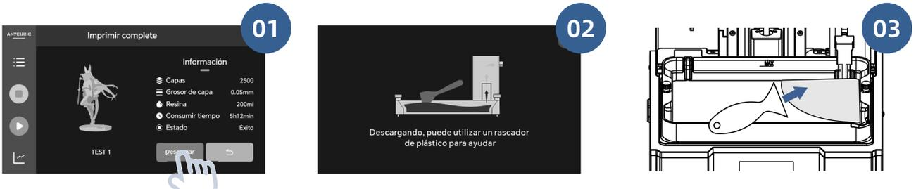
3. Active la función de limpieza de la cubeta cuando la resina esté parcialmente curada para evitar daños en la pantalla LCD y la impresora.
