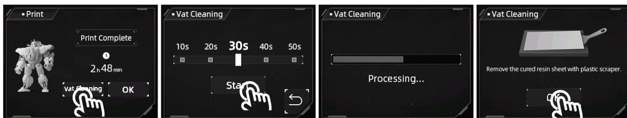
Retire la lámina de resina con un raspador de plástico
