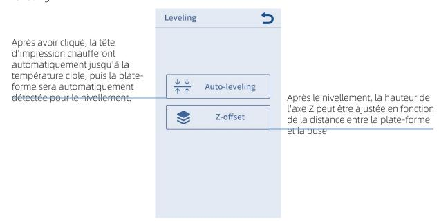
Remarque: En général, après le nivellement automatique, il n'est pas nécessaire d'effectuer une "Z-offset" pour affiner l'hauteur d'axe Z.
