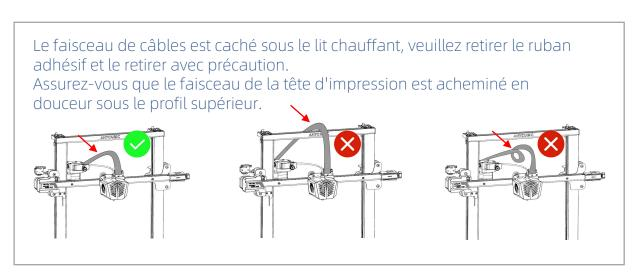
Insérez les faisceaux de câbles suivants dans les ports correspondants et assurezvous que les câbles sont solidement fixés.
