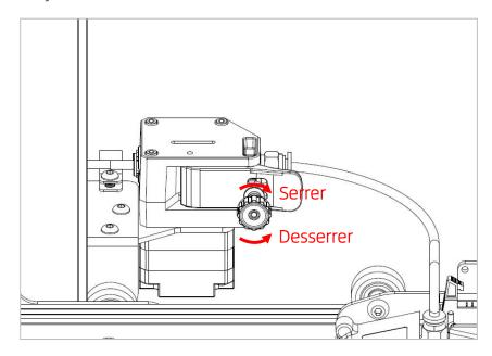
• Lorsque la décharge au niveau de la buse est mince ou que la décharge est cassée, veuillez desserrer l'écrou de l'extrudeuse pour réduire la force d'extrusion de l'extrudeuse.
