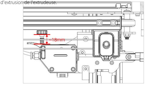
Comme le montre dans la figure ci-dessus, le filament avec une distance de vis de 18 mm est plus uniforme. Cette distance peut être affinée en fonction de la sortie filaire des différents filaments.
