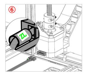
6.Déplacez la tête d'impression vers l'extrême gauche (par rapport à l'arrière), puis fixez le faisceau de la tête d'impression sur le support avec des vis M4 et des pinces en R. (Arrière)
