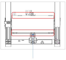
Fixez le verre en treillis à la plate-forme avec 6 clips.
