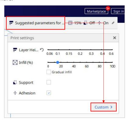
② Lors de l'impression du plus grand modèle (300 X 300 X 350 mm), le paramètre Build Plate Adhesion → Build Plate Adhesion Type doit être défini sur "None", sinon le modèle dépassera la plage d'impression de la machine.
