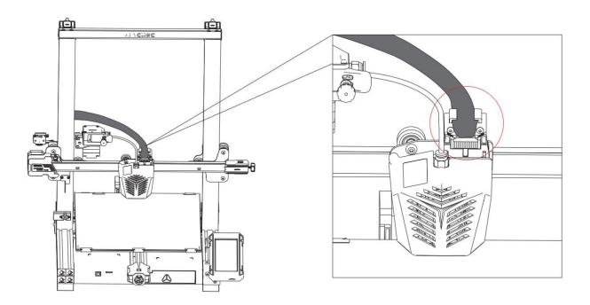
8. Attachez le faisceau de la tête d'impression et le tube en téflon avec une attache métallique, puis utilisez une attache pour fixer le faisceau de la tête d'impression à la plaque arrière de la tête d'impression.
