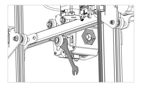
② Secouez la plate-forme d'impression. Si la plate-forme d'impression tremble de manière évidente, veuillez utiliser une clé à fourche pour tordre les entretoises hexagonales des roues en forme de D sous la plate-forme jusqu'à ce que la plate-forme ne tremble plus et se déplace en douceur sur l'axe Y.
