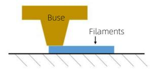
3 Si la buse est trop éloignée de la plate-forme, les filaments ne colleront pas efficacement à la plate-forme.
