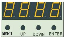
Menu key: Select function Up key: parameter increment Down key: Decreasing parameters Confirmation key: Confirm and sa
