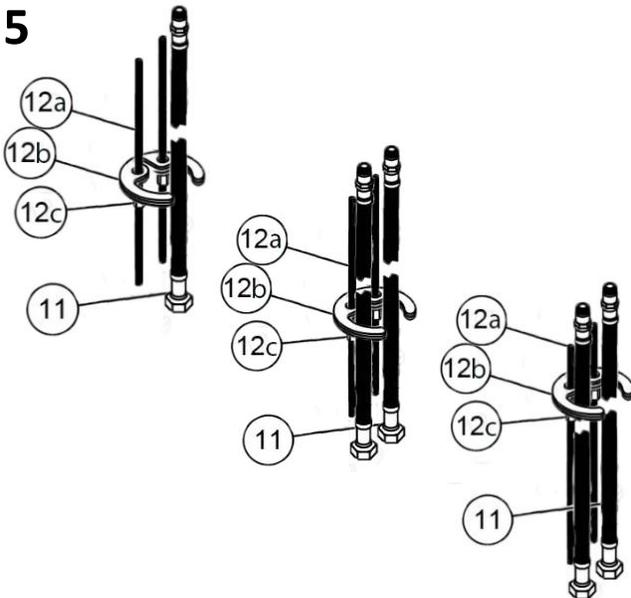
Veiller à bien mettre les flexibles (11) en position dans les creux des rondelles (12b).
