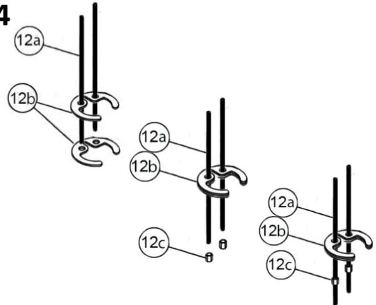
Sous le support, glisser les rondelles en forme de C (12b), celle en caoutchouc puis celle en métal, le long de la tige filetée (12a).
