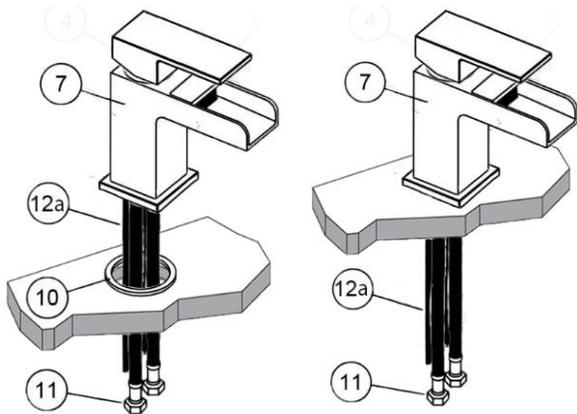
Glisser l'ensemble {corps du mitigeur (7), tige fileté (12a) & flexibles (11)} dans le trou de votre support. Il peut être nécessaire de faire passer un flexible à la fois.
