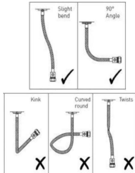
Connecter les flexibles (11) aux arrivées d'eau chaude et d'eau froide. Attention les flexibles ne doivent pas être pincés, tordus ou tendus.
