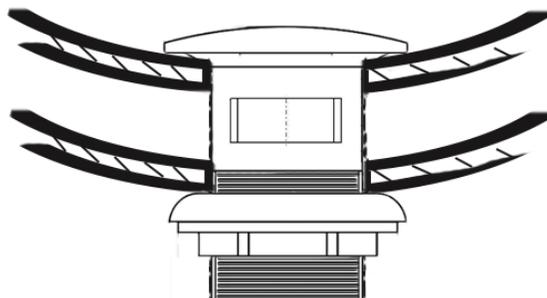
Exercer une pression sur le clapet lorsque celui-ci est en position basse va le basculer en position haute.
