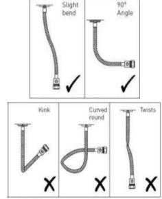
Connecter les flexibles (16) aux arrivées d'eau chaude et d'eau froide. Attention les flexibles ne doivent pas être pincés, tordus ou tendus.
