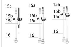
Veiller à bien mettre les flexibles (16) en position dans les creux des rondelles (15b).
