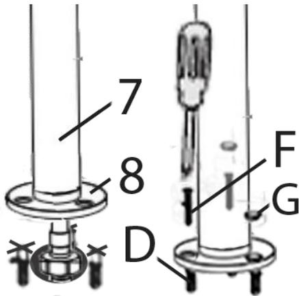
Refermer les arrivées d'eau, positionner le système, les trous des plaques de fixation (8) alignés avec les chevilles de fixation au sol (D), puis insérer dans chaque cheville (D) une vis (F), jusqu'à stabilisation de l'ensemble. Positionner les caches-vis (G) pour finir dans les trous des plaques (8).
