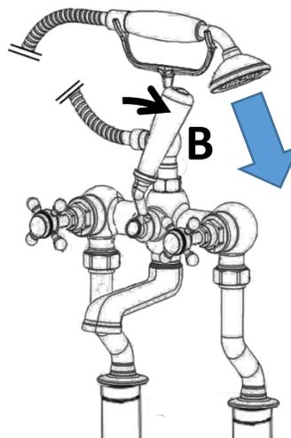
Lorsque la poignée centrale du corps du mélangeur est en position B, ce dernier fonctionne avec la sortie au niveau de la douchette.
