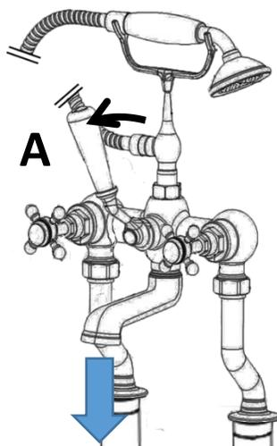
Lorsque la poignée centrale du corps du mélangeur est en position A, ce dernier fonctionne avec la sortie d'eau au niveau du bec verseur.
