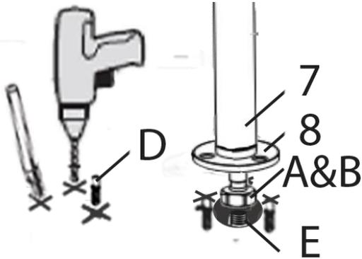
Dans le cas d'un sol béton : retirer le système de sa position, percer les trous au sol au niveau des points marqués précédemment, insérer des chevilles de fixation (D), puis raccorder les flexibles (A&B) aux arrivées d'eau (E).
