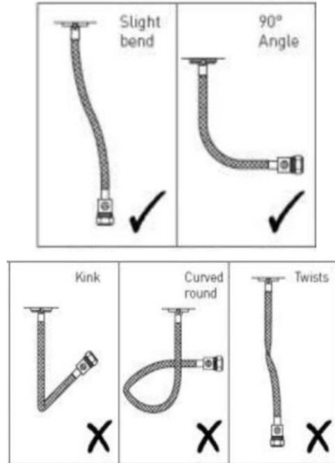
Vérifier que les flexibles de raccordement ne soient pas pincés, pliés ou tordus.
