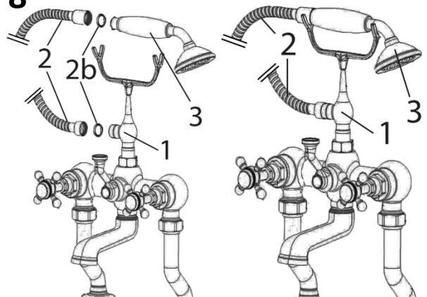
Visser le flexible de douche (2) au mélangeur (1). Visser ensuite la douche (3) au flexible (2). Prenez garde qu'un joint d'étanchéité (2b) soit bien présent à chaque extrémité du flexible (2) pour assurer l'étanchéité du système.
